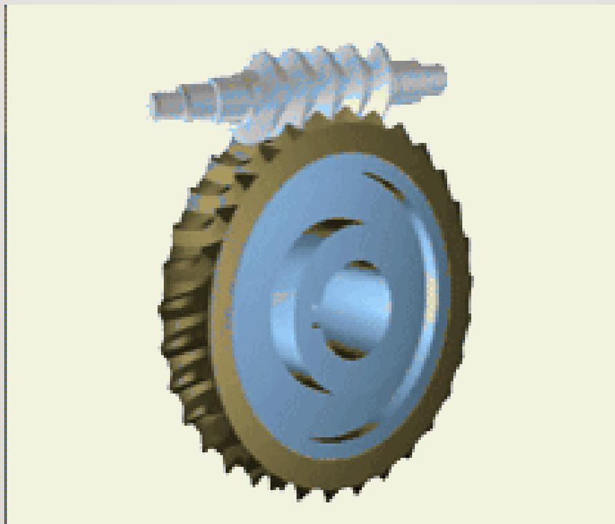
**齒輪嚙合傳動**：齒輪傳動是利用兩齒輪的輪齒相互嚙合傳遞動力和運動的機械傳動。具有結構緊湊、效率高、壽命長等特點。
